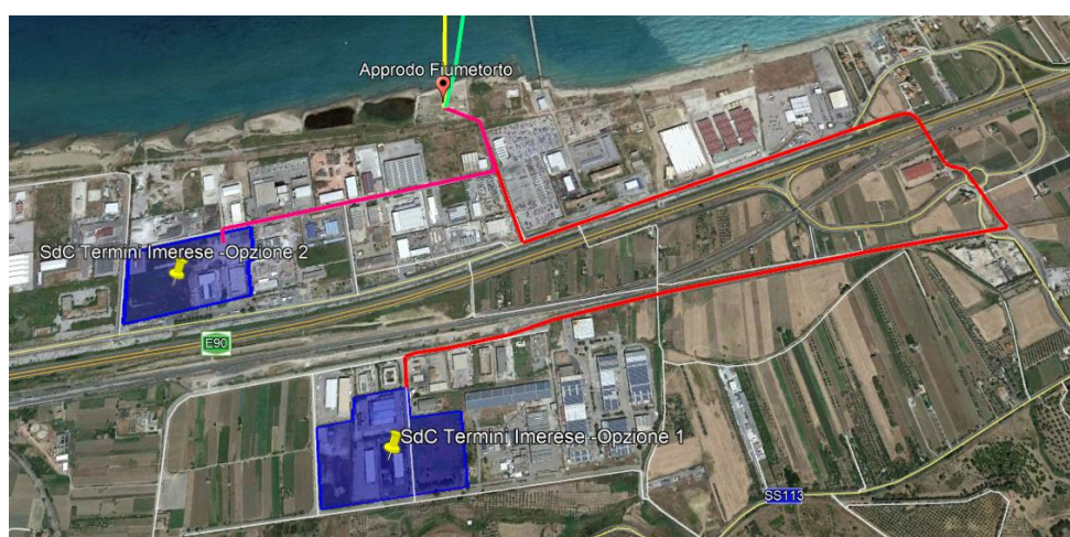
Figura 10 – Ortofoto dei tracciati dei cavi di polo ed elettrodo in Sicilia per opzioni di localizzazione n. 1 e n. 2 (fonte Google Earth)
